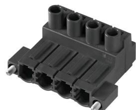
Conecotor macho invertido de 180° con conexión brida-tornillo para cables de hasta 2,5 mm<sup>2</sup> con un paso de 7,62. También ideal como solución con protección frente al contacto con los dedos para tensiones inversas. Cumple los requerimientos de las normas UL 1059 600 V, clase C, e IEC 61800-5-1. Variantes: disponible sin fijación lateral, con fijación externa o con gancho de fijación.
