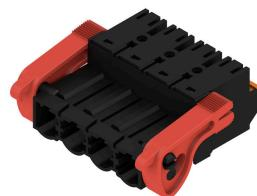
Conecotor macho invertido de 180° con conexión PUSH IN para cables de hasta 2,5 mm<sup>2</sup> con un paso de 7,62. También ideal como solución con protección frente al contacto con los dedos para tensiones inversas. Cumple los requerimientos de las normas UL 1059 600 V, clase C, e IEC 61800-5-1. Variantes: disponible sin fijación lateral, con fijación externa o con gancho de fijación.
