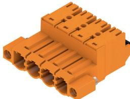
Conecotor macho invertido de 180° con conexión PUSH IN para cables de hasta 2,5 mm<sup>2</sup> con un paso de 7,62. También ideal como solución con protección frente al contacto con los dedos para tensiones inversas. Cumple los requerimientos de las normas UL 1059 600 V, clase C, e IEC 61800-5-1. Variantes: disponible sin fijación lateral, con fijación externa o con gancho de fijación.
