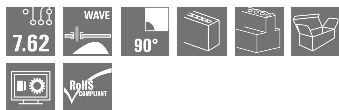
Conector hembra de 90° para placa de circuito impreso con un paso de 7,62. Cumple los requerimientos de la norma IEC 61800-5-1 y admite homologación UL conforme a UL840 600 V. Solución perfecta, con protección frente al contacto con los dedos, para la salida de potencia y aplicaciones de circuito intermedio.
