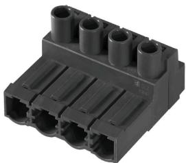
Conector macho invertido de 180° con conexión brida-tornillo para cables de hasta 2,5 mm<sup>2</sup> con un paso de 7,62. También ideal como solución con protección frente al contacto con los dedos para tensiones inversas. Cumple los requerimientos de las normas UL 1059 600 V, clase C, e IEC 61800-5-1. Variantes: disponible sin fijación lateral, con fijación externa o con gancho de fijación.
