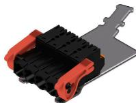
Conector macho invertido de 180° con conexión PUSH IN para cables de hasta 2,5 mm<sup>2</sup> con un paso de 7,62. También ideal como solución con protección frente al contacto con los dedos para tensiones inversas. Cumple los requerimientos de las normas UL 1059 600 V, clase C, e IEC 61800-5-1. Variantes: disponible sin fijación lateral, con fijación externa o con gancho de fijación. Conexión con apantallado enchufable prefabricada incluida para el apantallado de grandes áreas en su aplicación.
