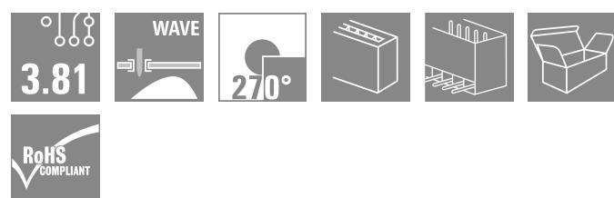
El conector macho SC con dirección de salida de 270°: el ángulo de 270° queda definido por la dirección de inserción y la espiga de soldadura y se corresponde con la dirección de inserción paralela a la placa de circuito impreso, aunque para la inserción de conectores hembra desde la cabeza.
