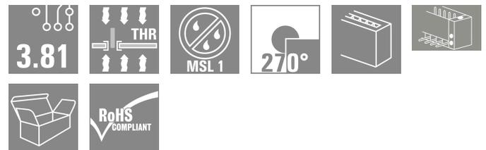
El conector macho resistente a altas temperaturas SC-SMT con dirección de salida de 270°: el ángulo de 270° queda definido por la dirección de inserción y la espiga de soldadura y se corresponde con la dirección de inserción paralela a la placa de circuito impreso, aunque para la inserción de conectores hembra desde la cabeza.
