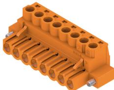
Conector hembra con conexión brida-tornillo para conexión de conductores con dirección de salida recta (180°). Los conectores hembra ofrecen espacio para la señalización y se pueden codificar. Sujetado mediante sujeción lateral o pasador de desbloqueo. Disponen también de un tornillo +/- integrado, protección contra inserción incorrecta del cable y se suministran con las bridas de embornado abiertas. HC = Alta intensidad
