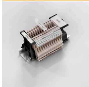
El portaequetas para conjuntos <B>SchT 5</B> se enclavará directamente en el carril TS 32 (guía perfil asimétrico) o en el carril TS 35 (guía perfil simétrico). De esta forma la regleta de bornes puede identificarse con una etiqueta independientemente de los bornes incluidos en la regleta.
