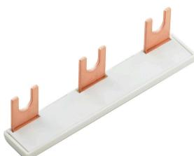
La distribución o multiplicación de un potencial a bornes contiguos se realiza a través de una conexión transversal. El esfuerzo adicional de cableado se puede evitar fácilmente. Incluso si los polos se rompen, la fiabilidad de contacto en los bornes sigue garantizada. Nuestro portafolio ofrece sistemas de conexión transversal enchufables y atornillables para bornes modulares.
