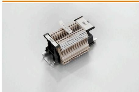
El portaetiquetas para conjuntos SchT 5 se enclavará directamente en el carril TS 32 (guía perfil asimétrico) o en el carril TS 35 (guía perfil simétrico). De esta forma la regleta de bornes puede identificarse con una etiqueta independientemente de los bornes incluidos en la regleta.
