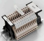
El portaetiquetas para conjuntos SchT 5 se enclavará directamente en el carril TS 32 (guía perfil asimétrico) o en el carril TS 35 (guía perfil simétrico). De esta forma la regleta de bornes puede identificarse con una etiqueta independientemente de los bornes incluidos en la regleta.
