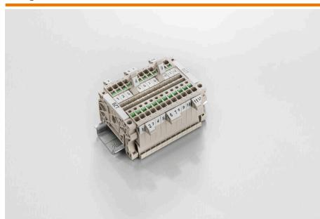
El soporte para señalizadores ofrece la posibilidad de montar adicionalmente señalizadores estándar con un paso de 5 ó 5,1 mm. Los soportes acodados se pueden encajar opcionalmente y se pueden montar en todos los canales de señalización estándar de los bornes modulares Klippon® Connect. Los tipos de señalizadores de ajuste se pueden encontrar en los respectivos accesorios del soporte de señalización.
