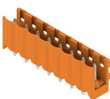
Conectores macho con dirección de salida recta. La longitud del terminal de soldadura está optimizada para la utilización de soldadura por ola. Los conectores macho ofrecen espacio para rotulación y se pueden codificar.
