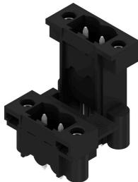
Conector macho resistente a altas temperaturas, de doble piso, desplazado lateralmente y cerrado, opcionalmente con brida para soldar. Terminal de soldadura 1,5 mm idónea para utilización de soldadura Reflow. Terminal de soldadura de 3,2 mm idóneo para soldadura Reflow y por ola. Los conectores macho ofrecen espacio para rotulación y se pueden codificar.
