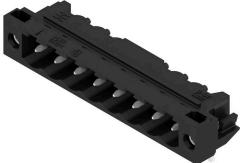
Conector macho resistente a altas temperaturas, embalado en caja o cinta. En cinta, con pin de soldadura de 1,5 mm, optimizado para el montaje automático. Pin de soldadura de 3,2 mm, indicado para soldadura reflow y por ola. Los conectores macho disponen de espacio para señalización y se pueden codificar. HC = Alta intensidad
