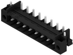
Conector macho abierto, recto y resistente a altas temperaturas. Embalaje en caja o cinta. En cinta, con pin de soldadura de 1,5 mm, optimizado para el montaje automático. Pin de soldadura de 3,2 mm, indicado para soldadura reflow y por ola. Los conectores macho disponen de espacio para señalización y se pueden codificar. HC = Alta intensidad
