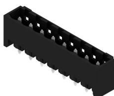
Conejero macho resistente a altas temperaturas, embalado en caja o cinta. En cinta, con pin de soldadura de 1,5 mm, optimizado para el montaje automático. Pin de soldadura de 3,2 mm, indicado para soldadura reflow y por ola. Los conectores macho disponen de espacio para señalización y se pueden codificar. HC = Alta intensidad
