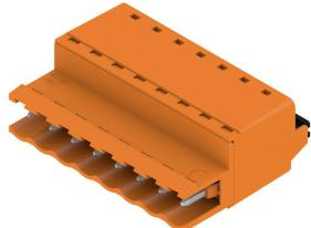
Conector macho con conexión PUSH IN y dirección de salida recta; se usa junto con BLF 5.08HC en la aplicación "wire-to-wire" como pasamuros. Los conectores macho disponen de espacio para rotulación y se pueden codificar.
