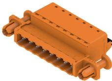
Conector macho con conexión PUSH IN y dirección de salida recta; se usa junto con BLF 5.08HC en la aplicación "wire-to-wire" como pasamuros. Los conectores macho disponen de espacio para rotulación y se pueden codificar.
