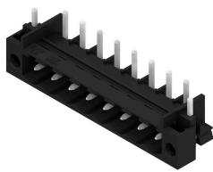
Conecotor macho abierto, recto y resistente a altas temperaturas. Embalaje en caja o cinta. En cinta, con pin de soldadura de 1,5 mm, optimizado para el montaje automático. Pin de soldadura de 3,2 mm, indicado para soldadura reflow y por ola. Los conectores macho disponen de espacio para señalización y se pueden codificar. HC = Alta intensidad
