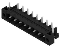
Conector macho abierto, recto y resistente a altas temperaturas. Embalaje en caja o cinta. En cinta, con pin de soldadura de 1,5 mm, optimizado para el montaje automático. Pin de soldadura de 3,2 mm, indicado para soldadura reflow y por ola. Los conectores macho disponen de espacio para señalización y se pueden codificar. HC = Alta intensidad
