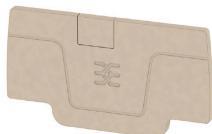
Las tapas de cierre se sujetan en la parte abierta del último borne antes del ángulo de fijación lateral. El empleo de la tapa de cierre permite mantener la función del borne así como la tensión nominal indicada. Además, garantiza una protección de contacto para las partes que soportan tensión. El borne final es a prueba de contacto con los dedos.
