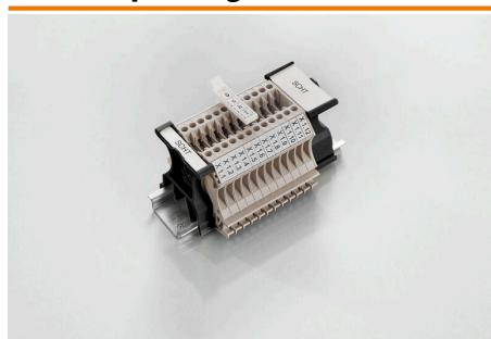
El portaetiquetas para conjuntos <B>SchT 5</B> se enclavará directamente en el carril TS 32 (guía perfil asimétrico) o en el carril TS 35 (guía perfil simétrico). De esta forma la regleta de bornes puede identificarse con una etiqueta independientemente de los bornes incluidos en la regleta.
