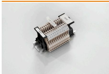
El portaequetas para conjuntos SchT 5 se enclavará directamente en el carril TS 32 (guía perfil asimétrico) o en el carril TS 35 (guía perfil simétrico). De esta forma la regleta de bornes puede identificarse con una etiqueta independientemente de los bornes incluidos en la regleta.
