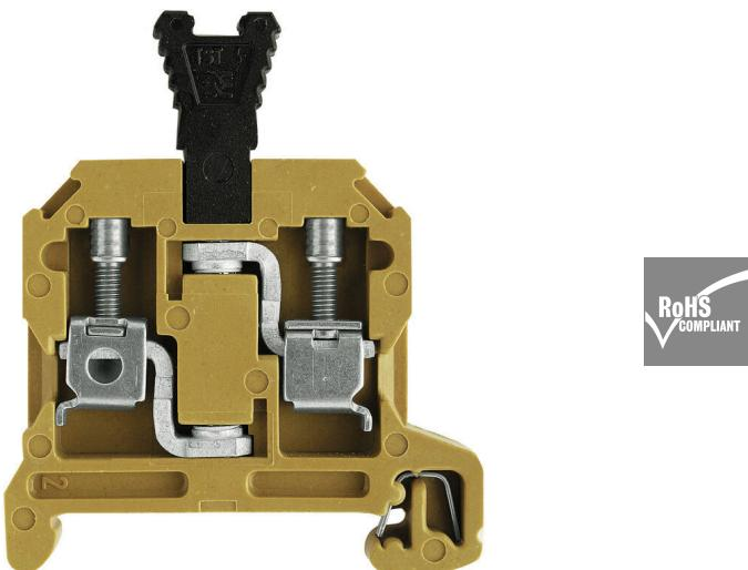
En algunas aplicaciones tiene sentido añadir una toma de prueba o un separador al borne con fines de prueba y seguridad. Los bornes seccionables de medición te permiten medir los circuitos eléctricos libres de tensión. Si bien la distancia de separación y de fuga de los puntos de desconexión no se evalúan en términos dimensionales, debe probarse la sobretensión de choque nominal especificada.
