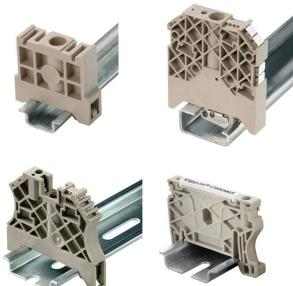
Para garantizar un asiento seguro y duradero sobre el carriel y para evitar el deslizamiento, Weidmüller dispone de los ángulos de fijación. Se dispone de diseños con o sin tornillo. Existe la posibilidad de colocar sobre el ángulo de fijación señalizadores, incluso señalizadores de conjunto y la posibilidad de alojar una conector de prueba.
