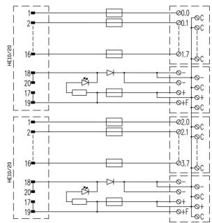
Das Schaltbild entspricht der Ausführung mit LEDs.
