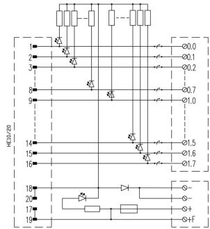
Das Schaltbild entspricht der Ausführung mit LEDs.
