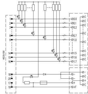
Das Schaltbild entspricht der Ausführung mit LEDs.
