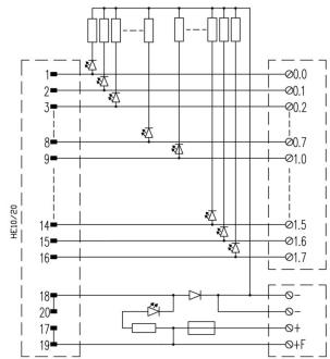
Das Schaltbild entspricht der Ausführung mit LEDs.
