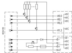
Das Schaltbild entspricht der Ausführung mit LEDs.
