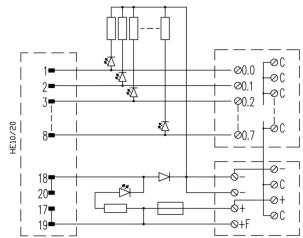
Das Schaltbild entspricht der Ausführung mit LEDs.
