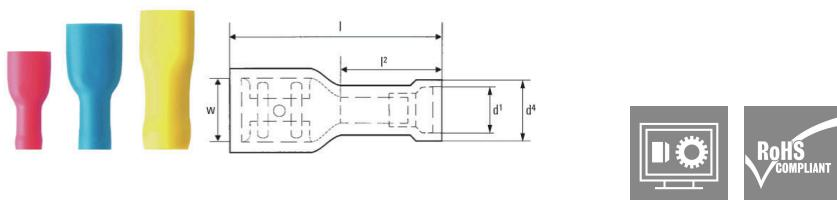
Voll isolierte Flachsteckhülsen aus PVC mit Kupferhülse
