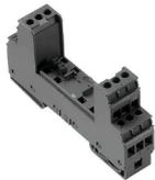
Basiselement für die steckbaren Ableiter VSPC. Integrierter PE-Fuß im Sockel des impedanzneutralen VSPC BASE sowie massiefreier PE-Anschluss (FG) über eingebaute Funkenstrecke, leitet bis zu 20 kA (8/20 µs) und 2,5 kA (10/350 µs) sicher zu PE ab. Geeignet für ungeerdete Signalkreise.
