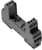
Basiselement für die steckbaren Ableiter VSPC, Integrierter PE-Fuß im Sockel des impedanzneutralen VSPC BASE, leitet bis zu 20 kA (8/20 µs) und 2,5 kA (10/350 µs) sicher zu PE ab.
