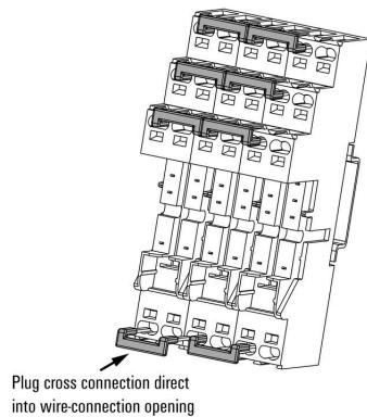
Stecken der Querverbindungen in die Kabelanschlüsse
