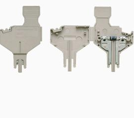
Der Bauelementstecker dient dem integrieren einer elektrischen Komponente in einer Trennreihenklemme. Nach dem Einlöten der jeweiligen Komponente lässt sich der Stecker in den Trennbereich unserer Reihenklemmen integrieren und ändert dadurch die Trennklemme zu einer Reihenklemme mit integrierter elektronischen Komponente.
