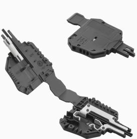
Der Sicherungshalter SIHA macht im Handumdrehen aus einer Trennklemme eine Sicherungsklemme: Einfach den Trennhebel entfernen und den Sicherungsstecker aufstecken.
