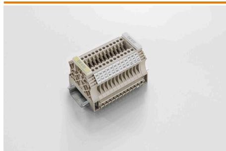
Der Endwinkelmarkierer EM 8/30 ist geeignet für die Kennzeichnung der Endwinkel WEW 35/2 und ZEW 35/2, wie auch als Gruppenschildträger für Klemmen der W-Reihe. Der EM 8/30 kann mit Einlegeschildern ESO 7/ESO 7P bestückt werden. Die Tasche gewährleistet einen hohen Schutz der Beschriftung vor Umgebungseinflüssen. Einstekschilder befinden sich unter Zubehör.
