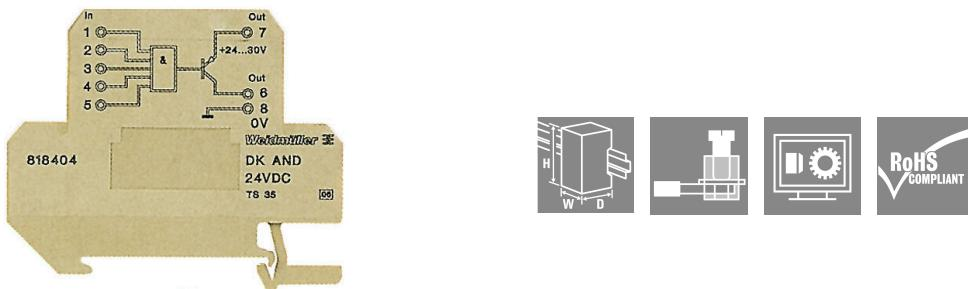
Logik Funktionen AND, NAND, OR und NOR in Reihenklemmenbauform mit einem Nennquerschnitt von 4 mm<sup>2</sup>. Sie verfügen jeweils über 5 Eingänge, die logische verknüpft, auf einen 24 V/ 20 mA PNP Ausgang ausgeben werden. Die Logik-Bausteine bieten ein breites Applikationsspektrum zur Kopplung digitaler Sensor-/Aktorsignale mit Automatisierungsgeräten.
