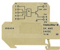
Logik Funktionen AND, NAND, OR und NOR in Reihenklemmenbauform mit einem Nennquerschnitt von 4 mm<sup>2</sup>. Sie verfügen jeweils über 5 Eingänge, die logische verknüpft, auf einen 24 V/ 20 mA PNP Ausgang ausgegeben werden. Die Logik- Bausteine bieten ein breites Applikationsspektrum zur Kopplung digitaler Sensor- / Aktorsignale mit Automatisierungsgeräten.
