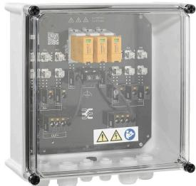
PV Next Generatoranschlusskästen für Wechselrichter mit 1 bis 12 MPP-Trackern werden zum Schutz der DC-Seite einer Photovoltaikanlage eingesetzt. Die Generatoranschlusskästen schützen den Wechselrichter gegen Überspannungen und erfüllen damit die Europäische Richtlinie CLC/TS 51643-32. Zusätzlich bieten diese Produkte die Möglichkeit die Anlage gegen Rückströme zu schützen und die Möglichkeit Strings zu kombinieren, um bei der Installation Kabel einzusparen.
