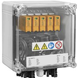
PV Next Generatoranschlusskästen für Wechselrichter mit 1 bis 12 MPP-Trackern werden zum Schutz der DC-Seite einer Photovoltaikanlage eingesetzt. Die Generatoranschlusskästen schützen den Wechselrichter gegen Überspannungen und erfüllen damit die Europäische Richtlinie CLC/TS 51643-32. Zusätzlich bieten diese Produkte die Möglichkeit die Anlage gegen Rückströme zu schützen und die Möglichkeit Strings zu kombinieren, um bei der Installation Kabel einzusparen.
