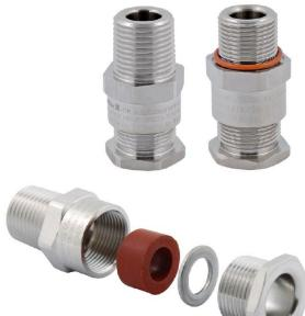
Kabelverschraubungen des Typs A2L sind für nicht armierte Kabel geeignet, sowie den druckfesten Ex d- und den Ex e-Explosionsschutz mit erhöhter Sicherheit zugelasse.
