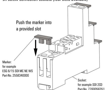
Montage des Markierers auf Sockeln mit Schraubanschluss (4 Steckplätze verfügbar)
