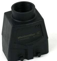
Kunststoff Gehäuse eignen sich besonders in Applikationen, in denen die Beständigkeit von Metallen nicht ausreicht. Darüber hinaus sind die hier gezeigten Gehäuse leichter und etwas preiswerter als Standard-Aluminiumgehäuse. Daher kann es sinnvoll sein in Anwendungen in den die Materialien nicht so robust sein müssen Kunststoffgehäuse zu verwenden. Die Dichtigkeit ist nach wie vor bei IP65.
