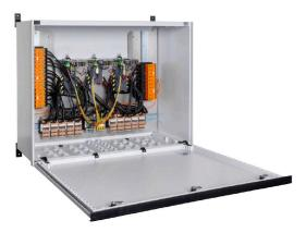
Für eine sichere Fernabschaltung Photovoltaik-Aufdachanlagen benötigen eine Abschalteinrichtung beim Eintritt der String-Leitungen ins Gebäude, die mit der Stromversorgung im Gebäude verbunden ist. So kann die Feuerwehr im Notfall Löscharbeiten durchführen, ohne unnötig gefährdet zu werden. Wird die Stromversorgung wiederhergestellt, schaltet der PV Next Feuerwehrschalter die PV-Strings automatisch wieder zu.
