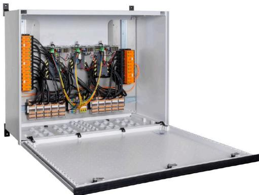
Für eine sichere Fernabschaltung Photovoltaik-Aufdachanlagen benötigen diese eine Abschalteinrichtung beim Eintritt der String-Leitungen ins Gebäude, die mit der Stromversorgung im Gebäude verbunden ist. So kann die Feuerwehr im Notfall Löscharbeiten durchführen, ohne unnötig gefährdet zu werden. Wird die Stromversorgung wiederhergestellt, schaltet der PV Next Feuerwehrschatzter die PV-Strings automatisch wieder zu.
