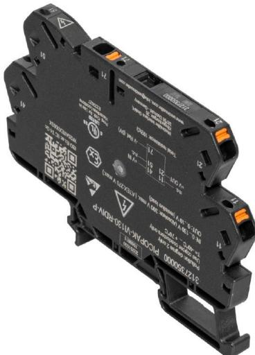
Trennverstärker, Passivtrenner, Grenzwertschalter und Messumformer – inklusive Temperaturmessumformer – im Reihenklemmenformat.
