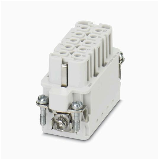
Die Push-In Anschlusstechnologie ist eine Direktstecktechnik. Der vorbehandelte Leiter kann ohne zusätzliche Hilfsmittel direkt in die Leiteranschlussebene gesteckt werden..
