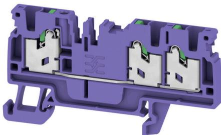
Das Durchführen von Energie, Signalen und Daten ist die klassische Anforderung in der Elektrotechnik und im Schaltschrankbau. Die maßgeblichen Merkmale sind dabei der Isolierstoff, die Anschlusstechnik und der Aufbau der Reihenklemmen. Mithilfe von Durchgangsreihenklemmen können ein oder mehrere Leiter zusammengeführt und/oder angeschlossen werden. Sie können eine oder mehrere Anschlusssebenen haben, die auf dem gleichen Potenzial liegen oder voneinander getrennt sind.
