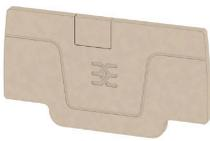
Abschlussplatten werden an der offenen Seite der letzten Reihenklemme vor dem Endwinkel befestigt. Mit dem Einsatz der Abschlussplatte wird die Funktion der Reihenklemme sowie die angegebenen Bemessungsspannung aufrechterhalten. Ein Berührungsschutz von Spannungsführenden Teilen wird gewährleistet, und die Abschlussklemme ist fingersicher.
