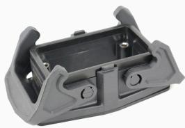
Kunststoff Gehäuse eignen sich besonders in Applikationen, in denen die Beständigkeit von Metallen nicht ausreicht. Darüber hinaus sind die hier gezeigten Gehäuse leichter und etwas preiswerter als Standard-Aluminiumgehäuse. Daher kann es sinnvoll sein in Anwendungen in den die Materialien nicht so robust sein müssen Kunststoffgehäuse zu verwenden. Die Dichtigkeit ist nach wie vor bei IP65.
