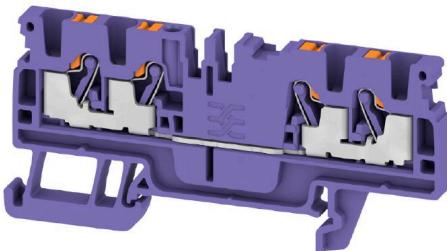
Das Durchführen von Energie, Signalen und Daten ist die klassische Anforderung in der Elektrotechnik und im Schaltschrankbau. Die maßgeblichen Merkmale sind dabei der Isolierstoff, die Anschlusstechnik und der Aufbau der Reihenklemmen. Mithilfe von Durchgangsreihenklemmen können ein oder mehrere Leiter zusammengeführt und/oder angeschlossen werden. Sie können eine oder mehrere Anschlusssebenen haben, die auf dem gleichen Potenzial liegen oder voneinander getrennt sind.
