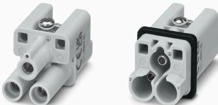
Die HQ Serie - Kleine Abmessungen und doch groß. Die elektrischen Kennwerte sprechen für sich. Die Leiteranschlussebene ist als Axialer Schraubanschluss ausgelegt. Diese Technik ermöglicht den Anschluss des Leiters ohne Spezialwerkzeug. Ein einfacher Innensechskantschlüssel reicht.
