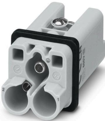
Die HQ Serie - Kleine Abmessungen und doch groß. Die elektrischen Kennwerte sprechen für sich. Die Leiteranschlussebene ist als Axialer Schraubanschluss ausgelegt. Diese Technik ermöglicht den Anschluss des Leiters ohne Spezialwerkzeug. Ein einfacher Innensechskantschlüssel reicht.
