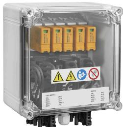
PV Next Generatoranschlusskästen für Wechselrichter mit 1 bis 12 MPP-Trackern werden zum Schutz der DC-Seite einer Photovoltaikanlage eingesetzt. Die Generatoranschlusskästen schützen den Wechselrichter gegen Überspannungen und erfüllen damit die Europäische Richtlinie CLC/TS 51643-32. Zusätzlich bieten diese Produkte die Möglichkeit die Anlage gegen Rückströme zu schützen und die Möglichkeit Strings zu kombinieren, um bei der Installation Kabel einzusparen.
